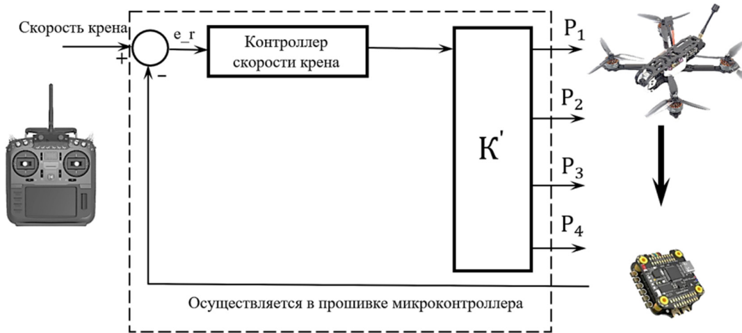
Рис. 4. Схема управления углом крена
