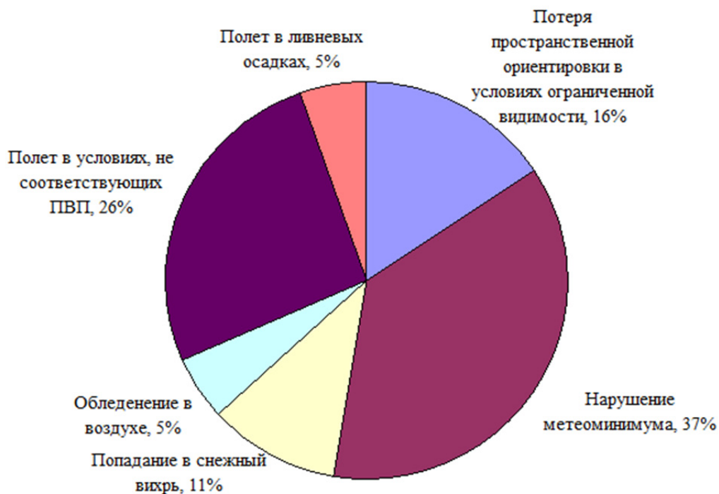
Рис. 5. Распределение причин авиационных происшествий, связанных с неблагоприятными внешними условиями для вертолетов за 2008–2014 гг.
