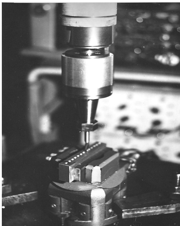
Рис. 1. Нарезание резьбы М8 с помощью ультразвукового устройства на специальных образцах
