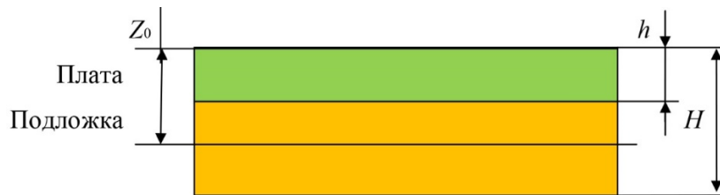
Рис. 5. Поперечное сечение печатной платы с металлической подложкой: h – толщина печатной платы; H – толщина ПУ; Z_0 – расстояние нейтральной поверхности ПУ от верхней граничной поверхности
