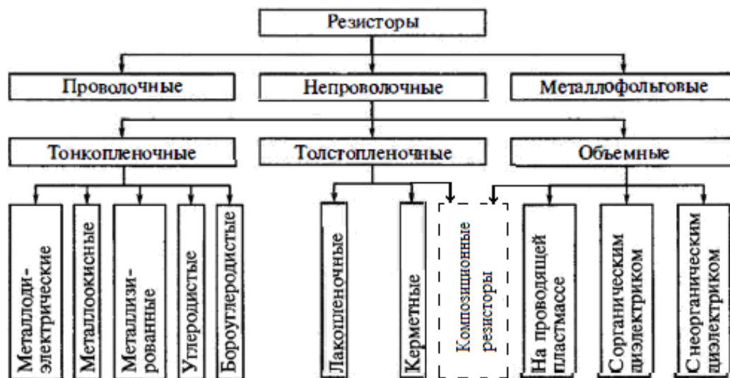
Рис. 1. Классификация резисторов по материалу резистивного элемента
