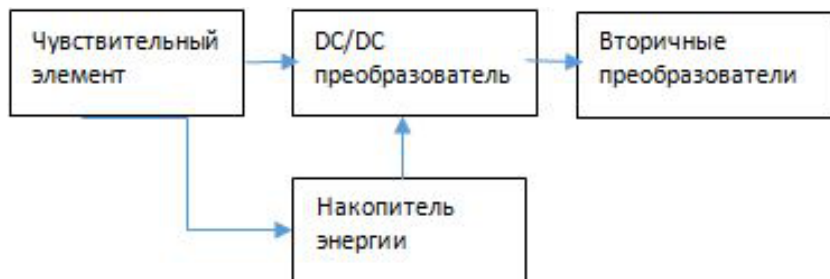
Рис. 2. Типовая структурная схема подсистемы электропитания сенсорной сети
