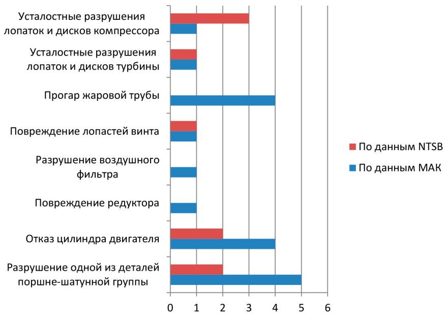
Рис. 3. Прочностные отказы и повреждения
