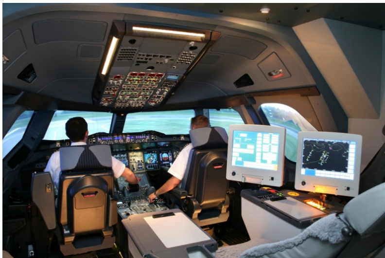
Рис. 2. Кабина авиационного тренажера устройством индикации с «широким зрачком» [5]
