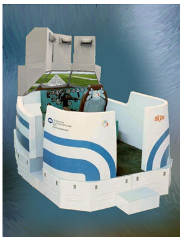
Рис. 5. Трехканальное устройство индикации ОКУ производства ОАО ПКБМ с «узким зрачком», установленное на пилотажном тренажере
