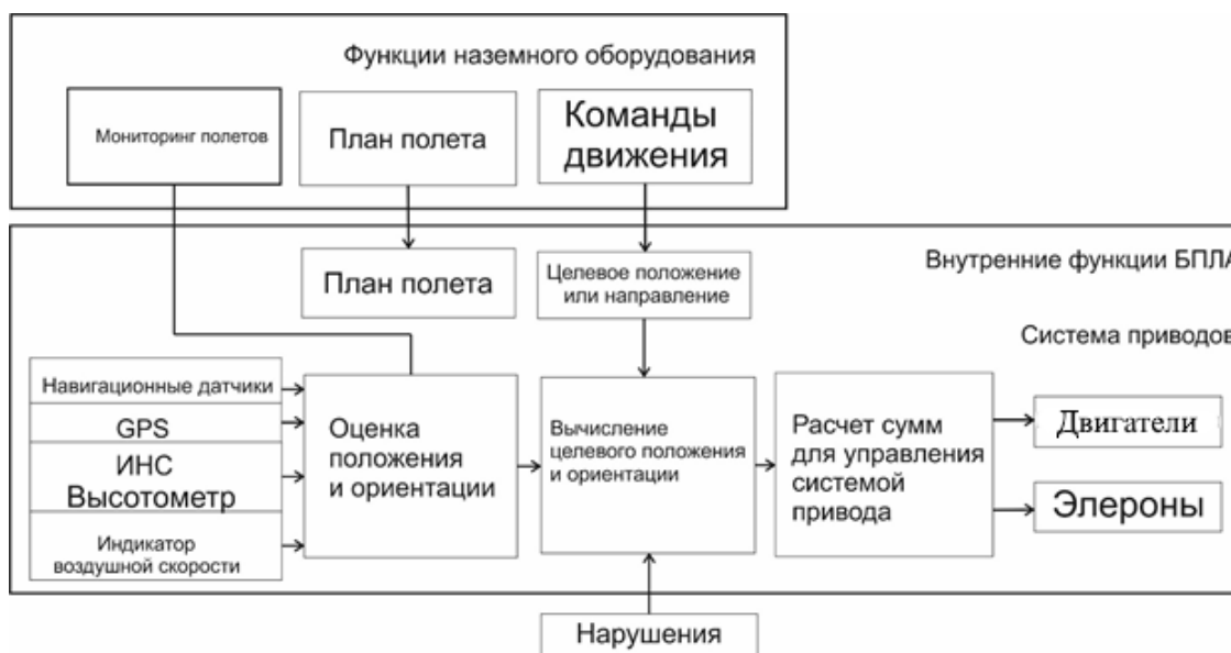
Рис. 2. Базовый вариант организации автономного управления полетом БПЛА
