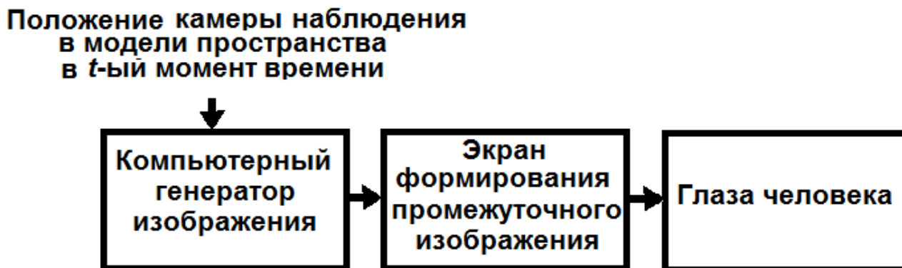
Рис. 2. Технологическая цепочка синтеза 2D-проекций 3D-объектов в тренажерах подготовки операторов БПЛА
