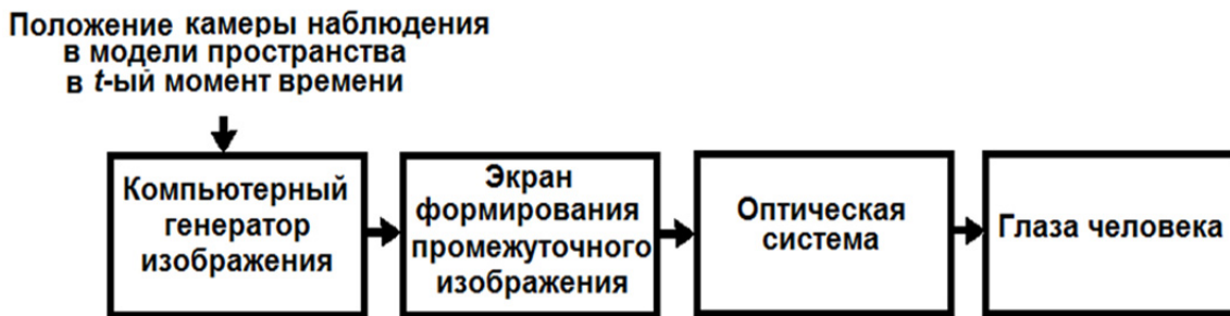
Рис. 1. Технологическая цепочка синтеза 3D-изображений 3D-объектов в АТ
