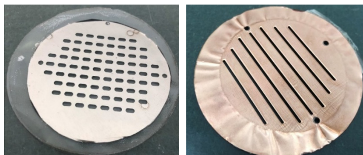
Рис. 3. Внешний вид заготовок с опрессованными электродами
