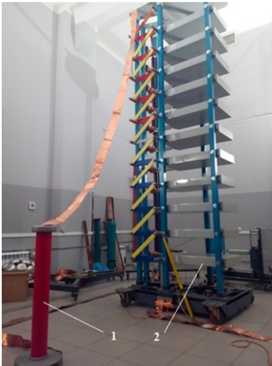
Рис. 3. Исследование метрологических характеристик ДНВ-140И на импульсном напряжении в высоковольтной лаборатории ФГУП «ВНИИМС»: 1 – делитель напряжений высоковольтный ДНВ-140И; 2 – государственный первичный специальный эталон единицы электрического напряжения стандартизованных грозовых и коммутационных импульсов в диапазоне от 1 до 1000 кВ (ГЭТ 204 – 2012)
