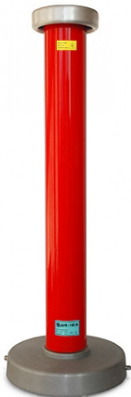
Рис. 2. Внешний вид делителя напряжения высоковольтного ДНВ-140И
