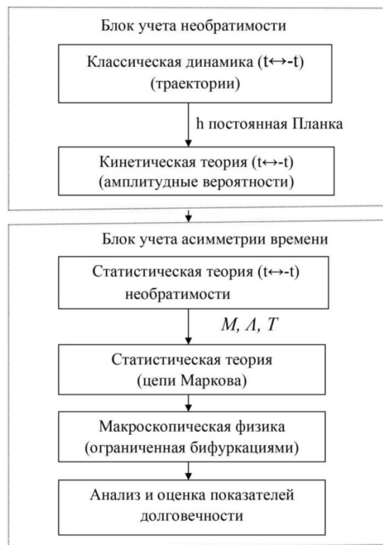
Рис. 2. Последовательность оценки и анализа состояния сложной системы с учетом уровней описания
