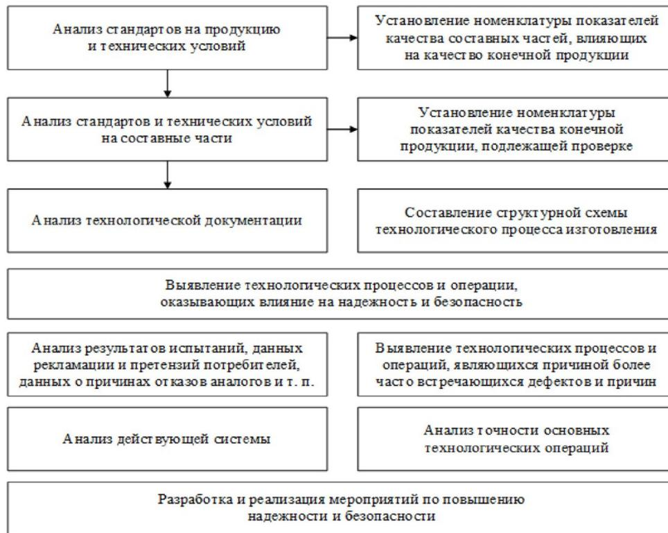
Рис. 3. Алгоритм анализа стандартов и параметров технологических процессов, влияющих на надежность и безопасность
