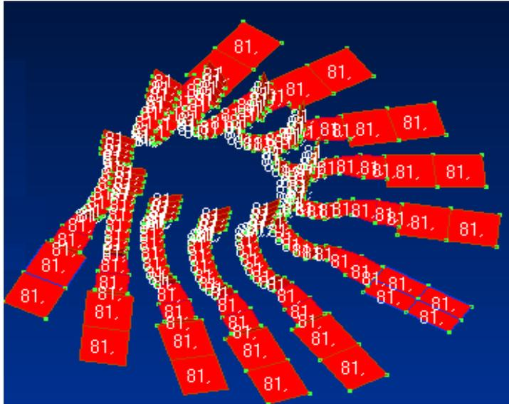
Рис. 2. Азотные криомосты, где задавалась постоянная температура в виде 81 К
