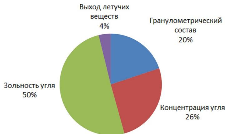
Рис. 8. Анализ релевантности факторов, определяющих реологические свойства
