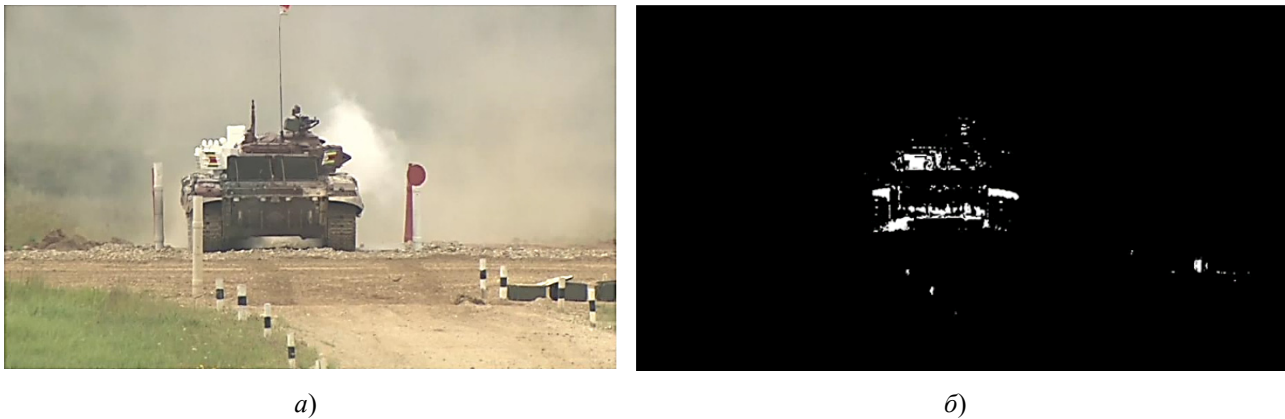
Рис. 5. Сегментация изображения методом Савола: а – исходное изображение; б – k = 0,15
