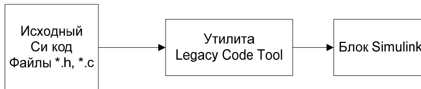
Рис. 4. Процедура интеграции Си кода в Simulink с использованием Legacy Code Tool
