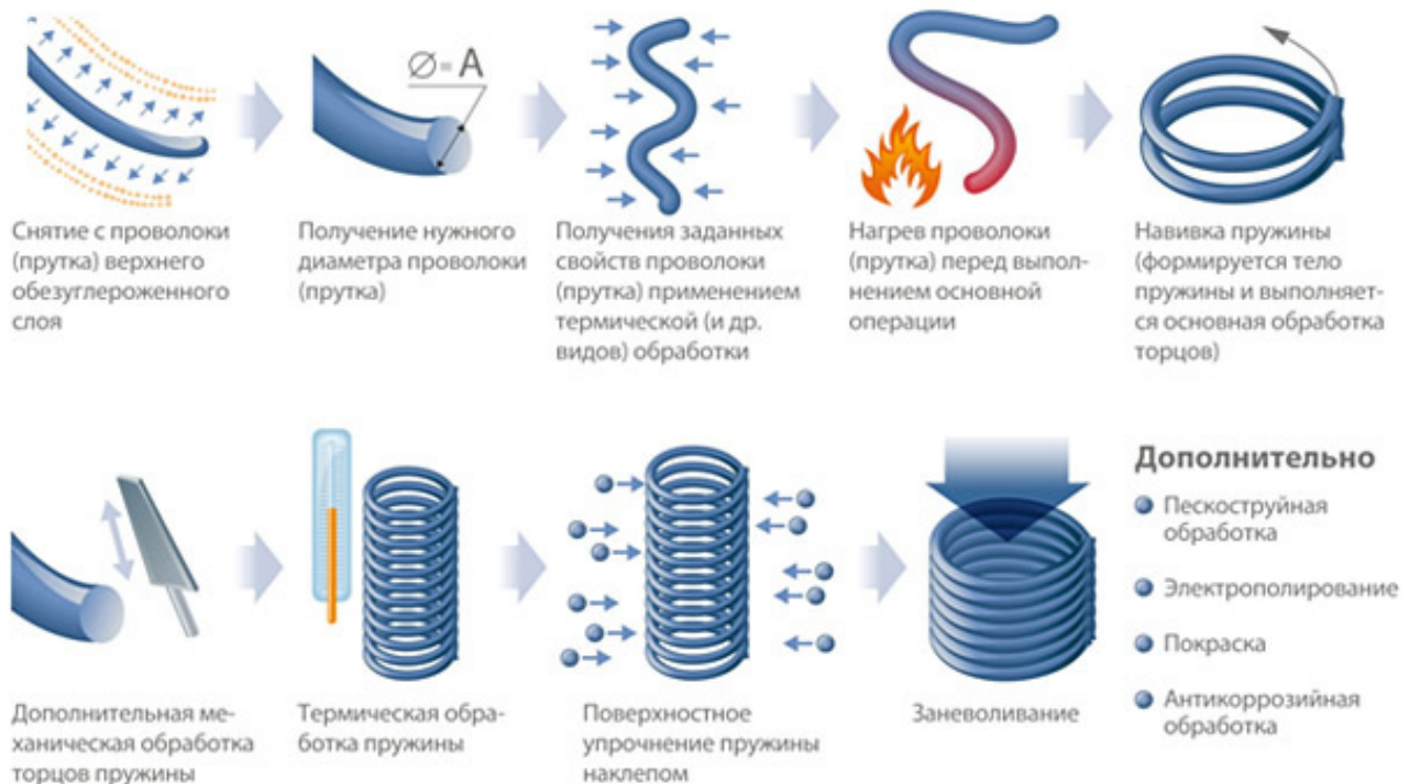
Рис. 2. Алгоритм технологии производства сверхпрочных пружин для подвижного состава и путевых машин
