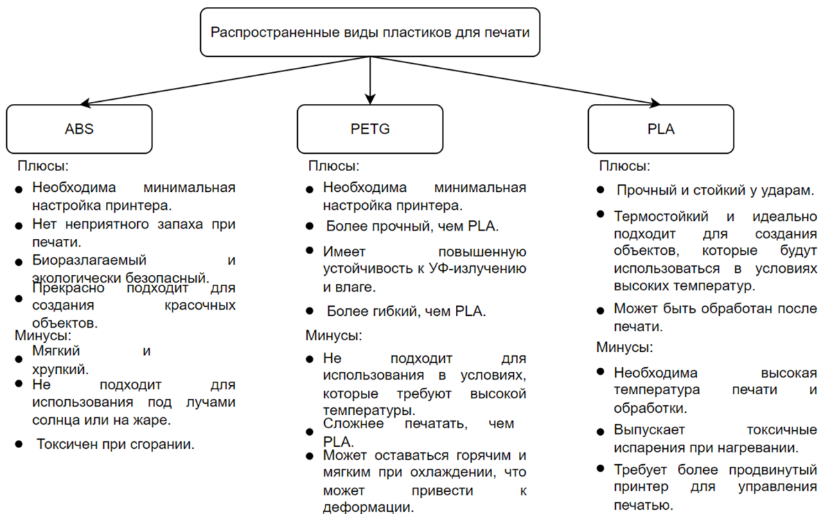
Рис. 5. Распространенные виды пластиков для печати
