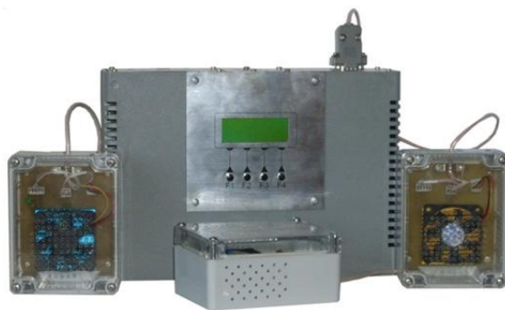
Рис. 3. ИИК с набором сменных блоков
