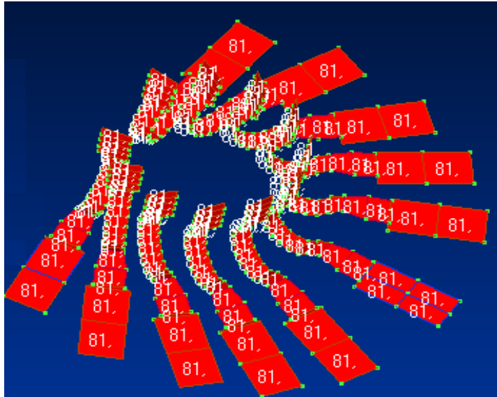
Рис. 2. Азотные криомосты, где задавалась постоянная температура в виде 81 К
