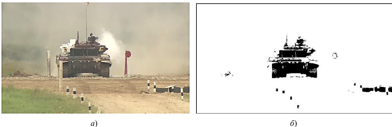
Рис. 2. Сегментация изображения методом Оцу: а – исходное изображение; б – метод Оцу
