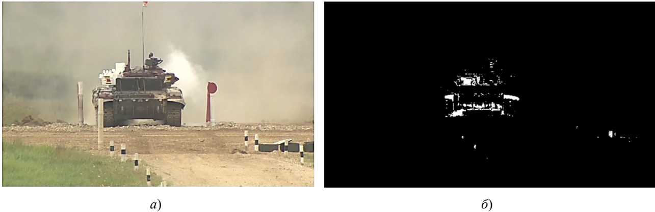
Рис. 5. Сегментация изображения методом Савола: а – исходное изображение; б – k = 0,15
