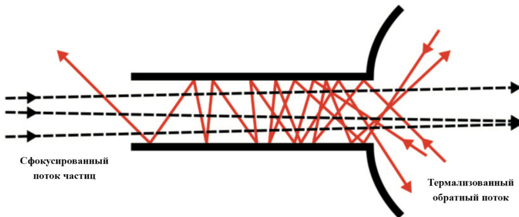
Рис. 1. Принцип работы коллектора
