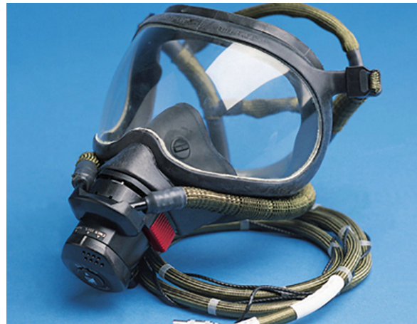
Рис. 4. Кислородная маска в кабине ВС
