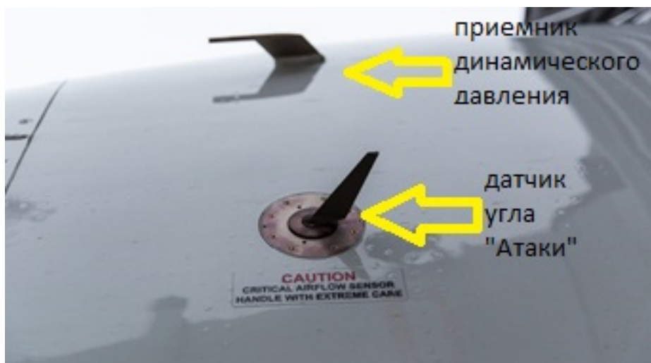
Рис. 3. Приемник динамического давления и датчик угла «Атаки»
