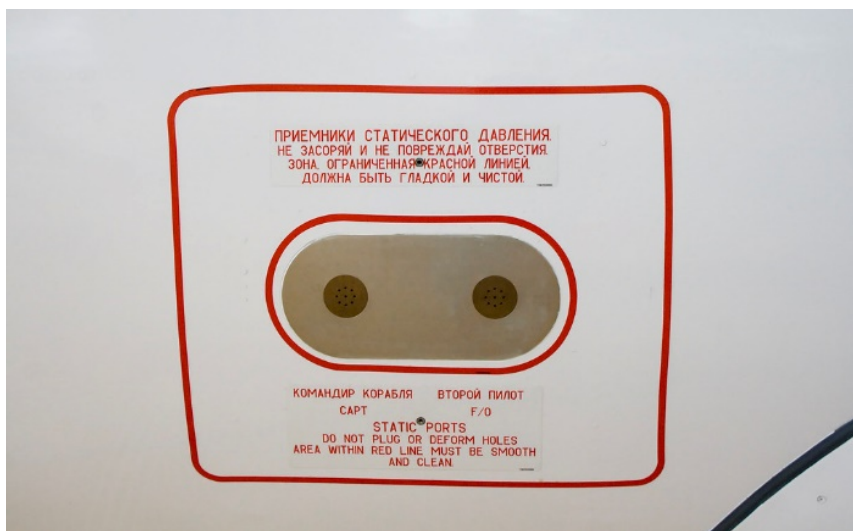
Рис. 2. Приемник статического давления с нанесенной защитной пленкой
