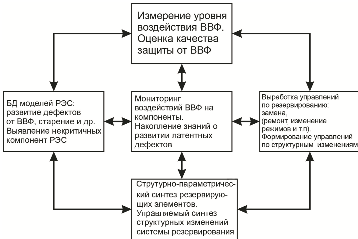
Рис. 1. Структура системы синтеза адаптивных самовосстанавливающихся РЭС на основе интеллектуального резервирования
