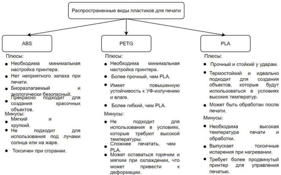
Рис. 5. Распространенные виды пластиков для печати
